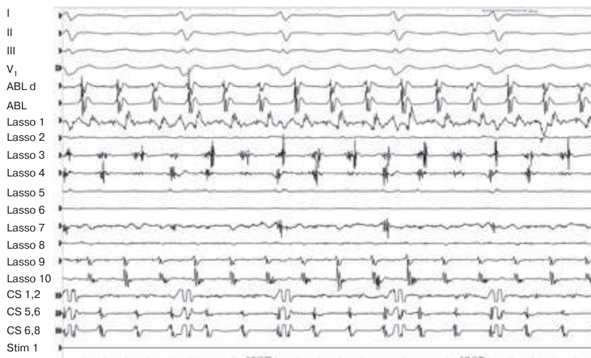
Рис. 6. Триггерная активность ЛВ во время пароксизма ФП. Длительность цикла на электроде ВС около 200 мс, в ПВЛВ – 150–200 мс, в ЛВЛВ – 100 мс.
